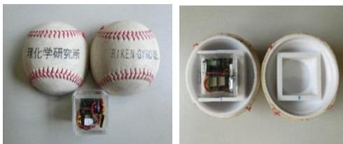
図1 加速度センサ内蔵ボール
